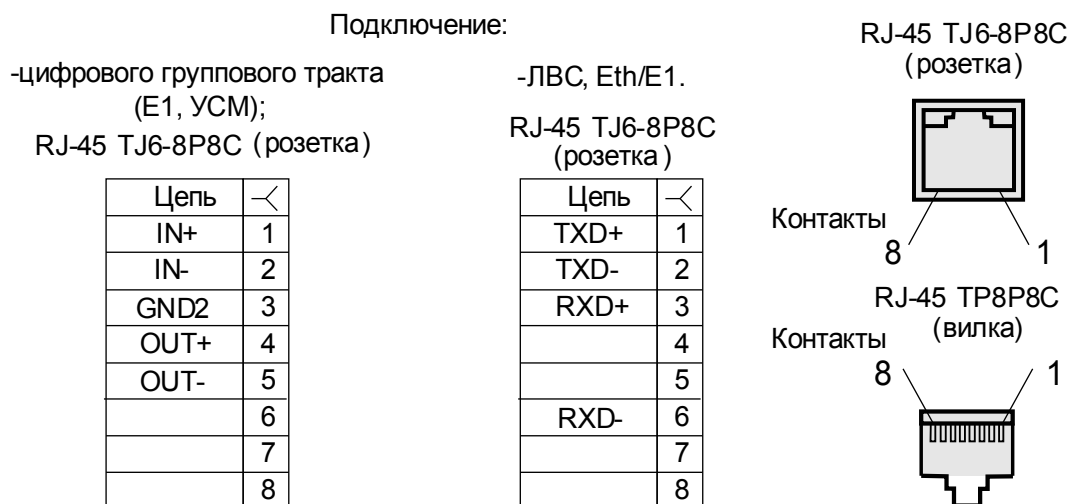
Рисунок 13.5 – Подключение к соединителям ЛВС, Eth/E1, ИКМ1, ИКМ0
